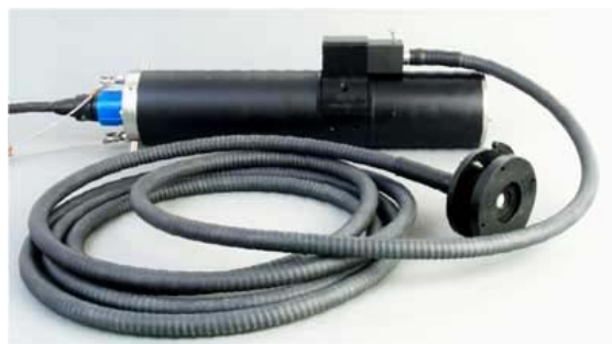
Abbildung 6: Bentho-Fluor; Fluorometer zur in-vivo-Messung der Algen-Fluoreszenz.
